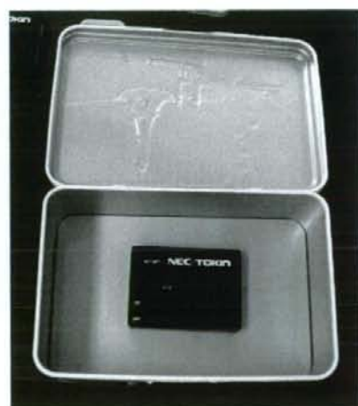
図9 スチール製容器による通信調査
