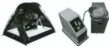
(図 2) 左は実際の低酸素テント (Hypoxic Tent System) で、右が低酸素発生器 (HYPOXIC GENERATOR) である。テント内の酸素分圧が定常状態になるのに約 1 時間かかる。
