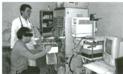
図2 実際の呼気NO測定装置 SEIVERS社のNITRIC OXIDE ANALYZER NOA™ 280.
