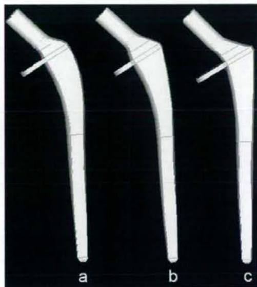
図3 aコントロール bカラー下断面中心を、外側に5mm水平移動したCal 5 cカラー下断面中心を、外側に10mm水平移動したCal10
