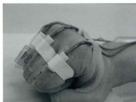
図2 固定法2) 1軸電気角度35型 (Biometrics, UK) を基節骨、中手骨上の皮膚に両面テープと弾力性のある絆創膏で固定している。
