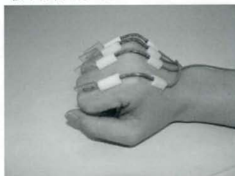
図1 固定法 1) 1軸電気角度 35 型 (Biometrics、UK) を基節骨、中手骨上の皮膚に両面テープのみで固定している。
