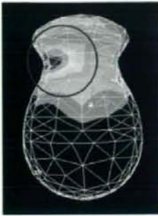
図1; 新コンポーネントの有限要素応力解析 コンポーネントのフード基部で上方偏位する 骨頭による応力が発生していることが示された (前報より引用)
