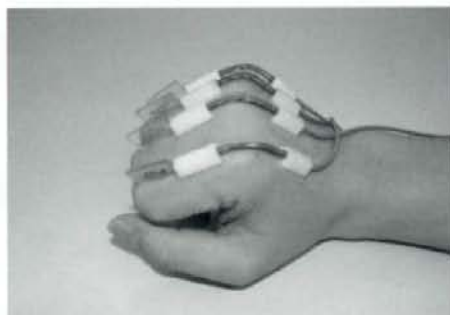
図 10. 固定法 1) 1軸電気角度 35 型 (Biometrics, UK) を基節骨、中手骨上の皮膚に両面テープのみで固定している。
