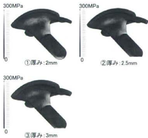
図 10. 人工足関節を距骨側から見た von Mises 相当応力分布
