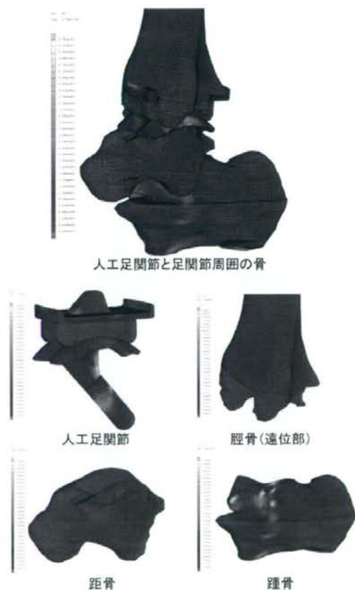
図 11. 骨形態を考慮した人工足関節の von Mises 相当応力分布
