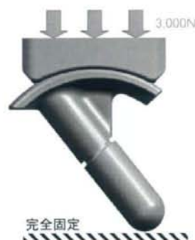
図 5. 人工足関節単体での FEM 解析モデル
