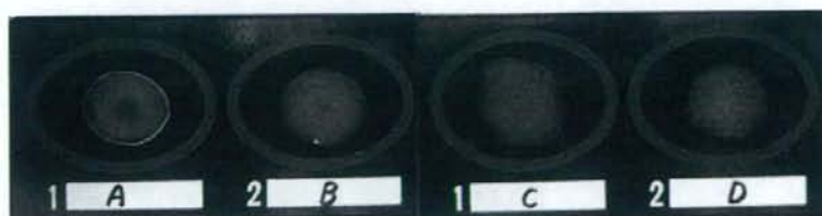
図-6、ジアルジア感染ヒト糞便試料を用いたラテックス凝集試験
