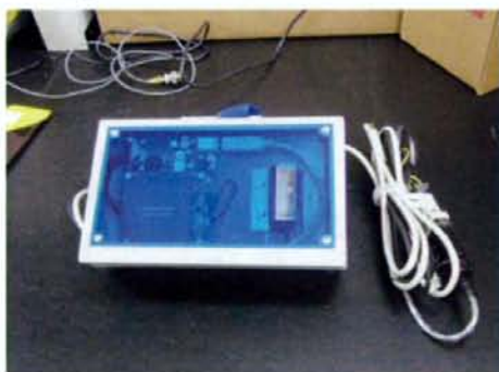
写真：ICタグリーダー・バーコードリーダー一体型装置
