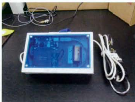
写真：ICタグリーダー・バーコードリーダー 一体型装置 試作機 外観
