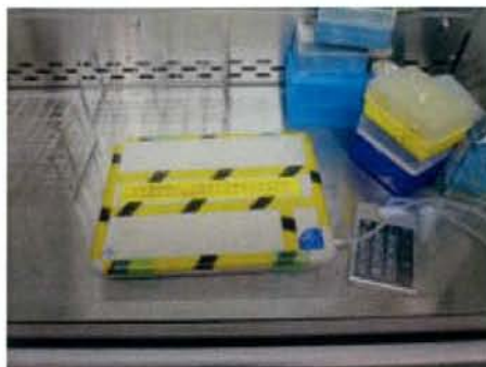
写真：安全キャビネット内に配置したアンテナ
