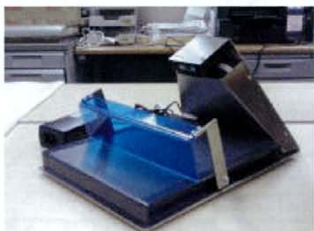
写真：情報収集・伝達端末タイプ1 ② (ICタグ読取り装置)
