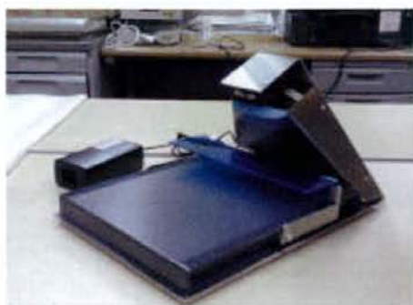
写真：情報収集・伝達端末タイプ1 ① (ICタグ読取り装置)
