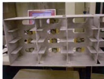
図 C-2-2 保管枠へのアンテナ取付け
