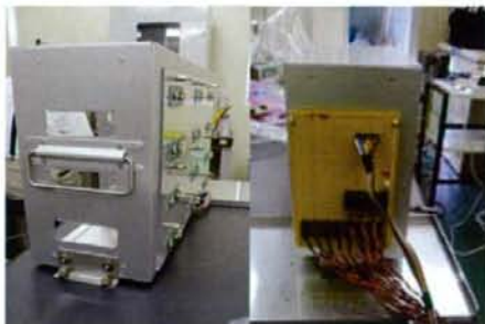
図 C-2-11 リレー基盤取付け
