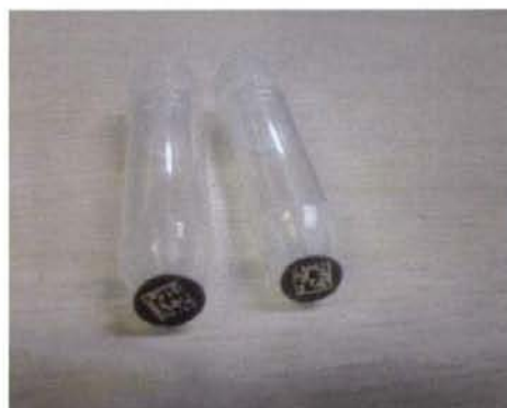
図2. 二次元バーコードレーザー刻印試料容器 (B)
