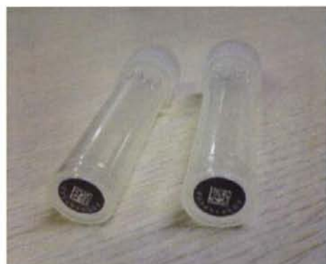
図1. 二次元バーコード埋め込み試料容器 (A)
