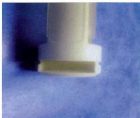
図 9. 容器 D、IC タグ取付け部分。
