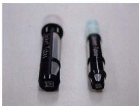
図3. ジャケット式二次元バーコードレーザー刻印試料容器 (C)
