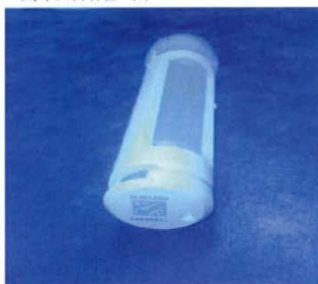
図4. 二次元バーコードレーザー刻印試料容器 (D)
