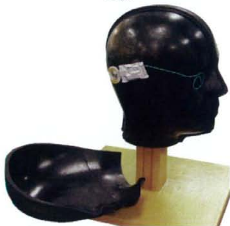
図18. EMC評価用固体ファントム
