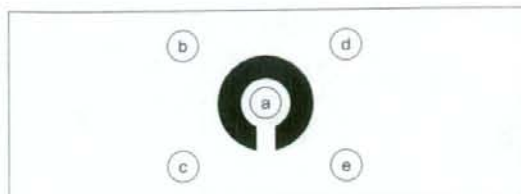
図1 背景輝度の測定場所 0.1の視標の周囲5ヵ所を、液晶モニターおよび従来型の2機種 の標準視力検査装置で測定した。
