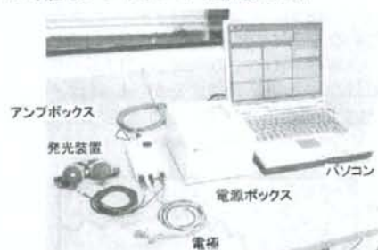
図1. 新しい皮膚電極 ERG 装置の構成
