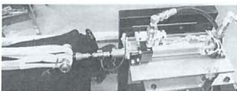
図10 引張試験治具取り付け
