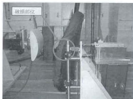
写真7 ピンバー破損部位
