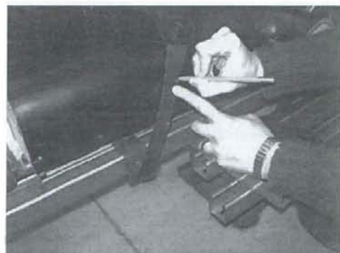
図3 ベルトの伸びの測定
