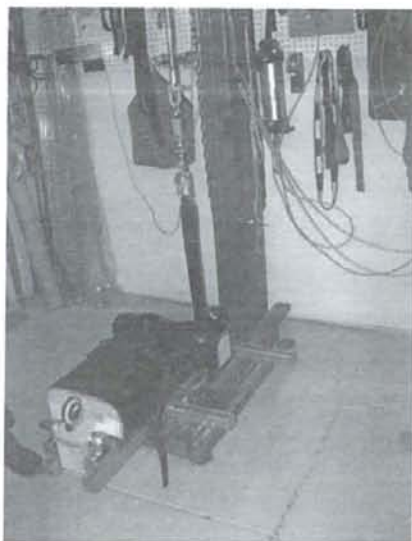
図2 ダミーにベルトを装着し、試験装置にかけた状態
