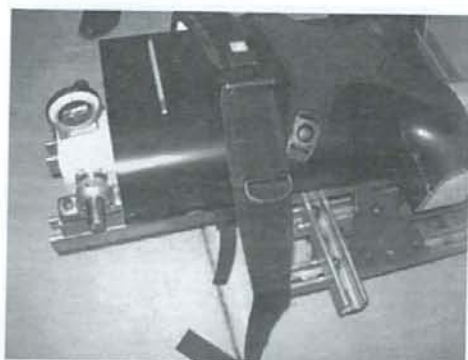
図4 骨盤ベルトでの伸びの測定
