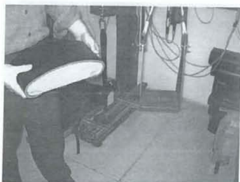
図5 骨盤ベルトの負荷装置と断面。右に三角の支持装置がある。
