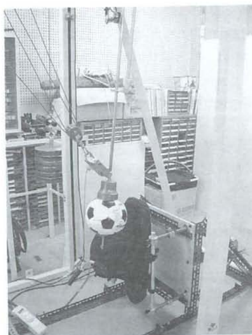
図13 背支持部の衝撃試験2 (ISOの条件で試験を実施)
