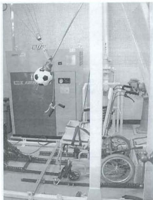
図10 背支持部後方衝撃試験
