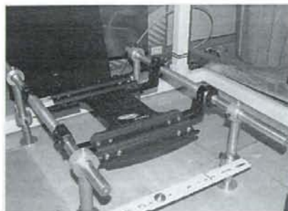
図14 座支持部の衝撃試験用治具
