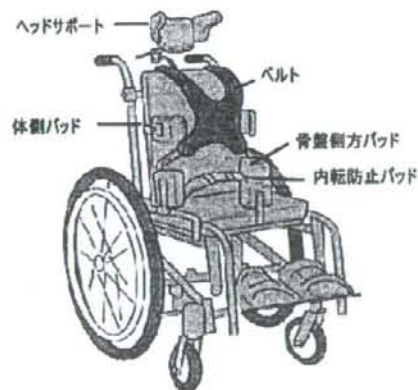
図19 車いすフレームに組み込まれた座位保持装置
