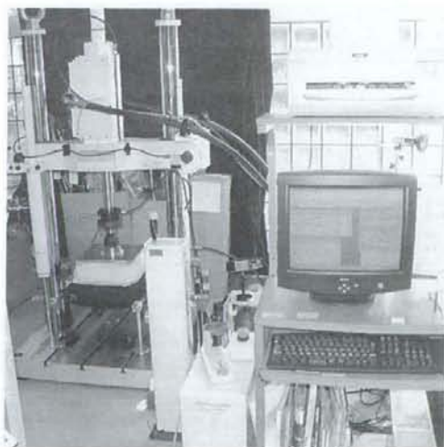
図16 電気油圧サーボ式材料試験機
