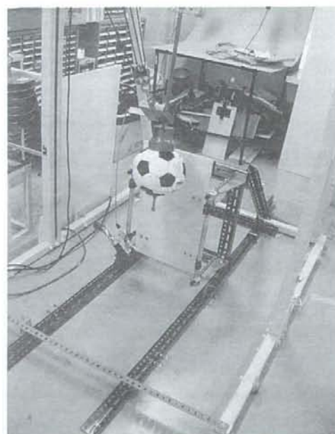
図11 背支持部の衝撃予備試験 (ISOの試験方法)
