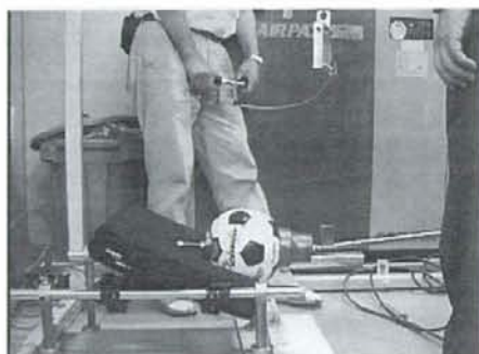
図15 座支持部の衝撃試験
