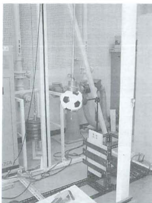
図9 頭部支持部の衝撃試験
