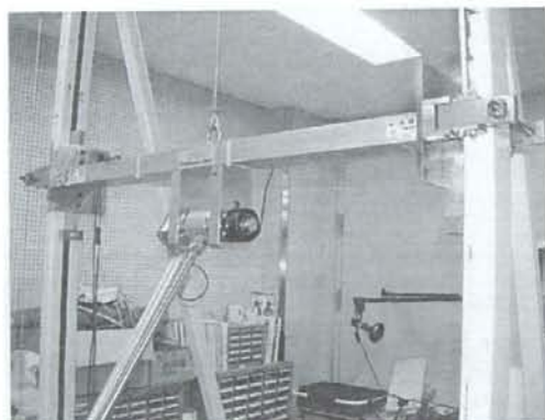
図5 座位保持用衝撃試験機（改良品）クロスヘッド部
