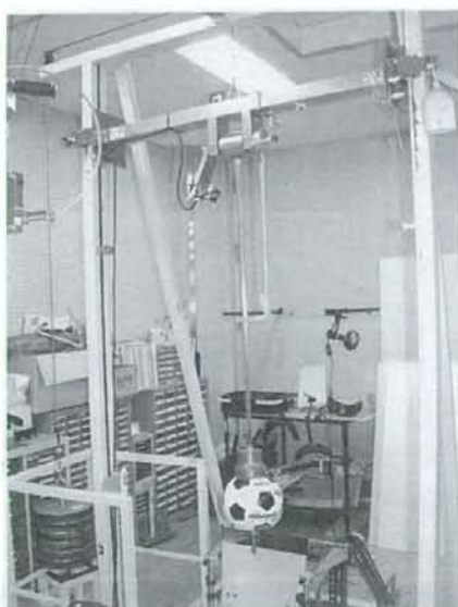
図3 座位保持用衝撃試験機のクロスヘッド部分（初期型）
