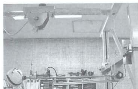
図7 座位保持用衝撃試験機（改良品）おもりと角度設定アーム、つり上げ部
