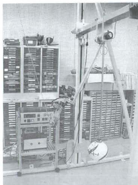
図6 座位保持用衝撃試験機（改良品）クロスヘッド、おもり、制御装置
