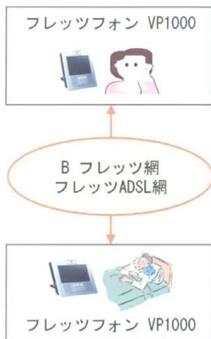
図10 ひかり電話網およびADSL網を利用したテレビ電話システム
