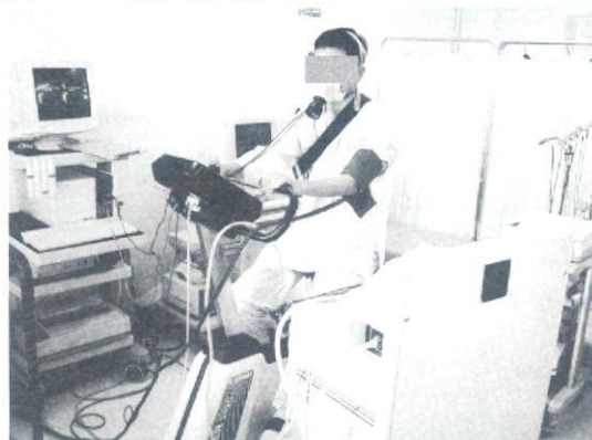
自転車エルゴメータの横にあるのが制御駆動装置
