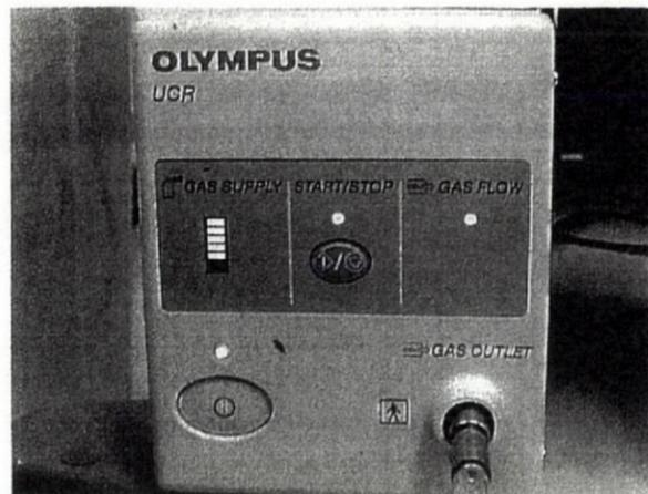
図2 プロトタイプCO<sub>2</sub>ガスレギュレーター
