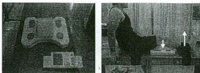
図1. 開発した簡易筋力測定器 骨盤帯と下腿遠位部をバンド固定し、膝関節を伸展させた際の膝窩部に生ずる力を測定する。
