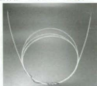
使用する光ファイバーの曲げの様子
