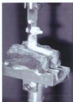
図13. レオメーターでの硬膜—椎体破断張力の測定
