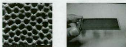
図1 LSPRチップの表面構造と全体写真
