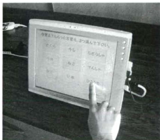
図1 タッチパネル式コンピュータを用いた認知症スクリーニング検査機器の実物(物忘れ相談プログラム)
