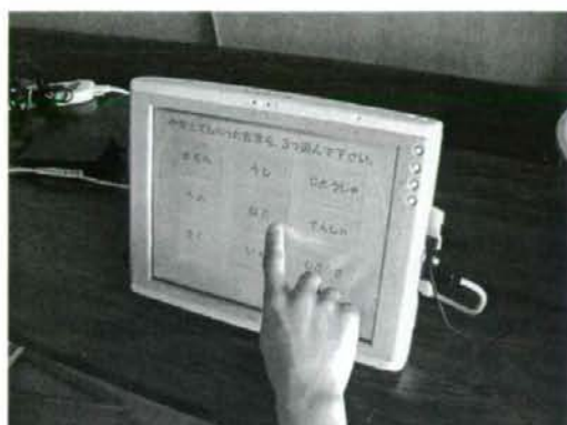
図1 認知症スクリーニング機器 (タッチパネル式コンピューター)
