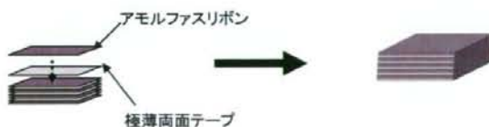
図 1 アモルファスリボン積層磁心の作製の流れ
