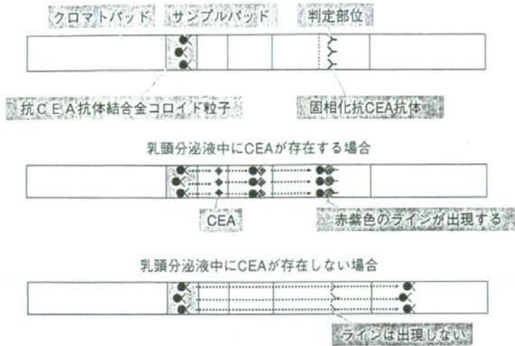
図1 イムノクロマトグラフィー法(ラナマンモカードCEA ® )による乳頭分泌液中CEAの測定原理
