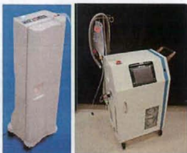
図8. 初期型冷却水灌流装置(左)と、改良型冷却水灌流装置(右)改良型は灌流液温度、灌流圧データを冷却カフより取得し自動制御を行う。
