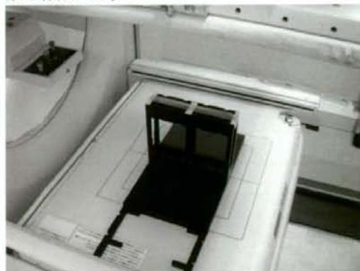
図1 コリメータ応答関数作成のためのラインソースのプラナー像収集のセットアップ
