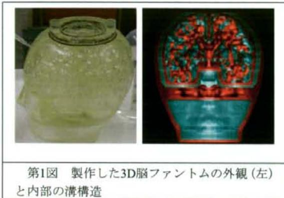
第1図 製作した3D脳ファントムの外観(左)と内部の溝構造
