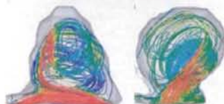
Fig.2 レーザーによる流れの3次元可視化（破裂例（図左）では後壁側（手前左）に流れが衝突しジェット流を形成するのに対し、未破裂例（図右）では流れの衝突はなく旋回流を形成する。色は流速を示し、赤は流速が高いことを示す。）
