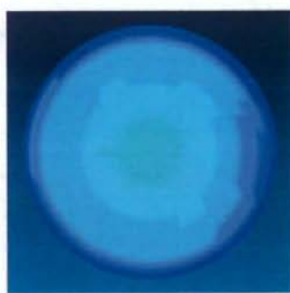
図 11-B. シミュレーション試験 1000 万回後の PMPC 処理 CLPE ライナー (32 mm) の摺動面コンター図
