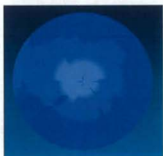
図 10-B. シミュレーション試験前の CLPE ライナー (40 mm) の摺動面コンター図
