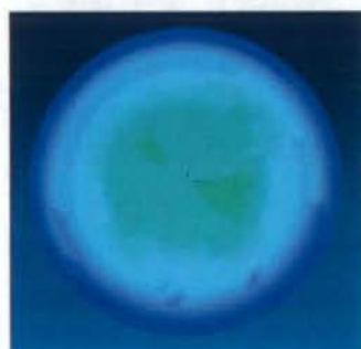
図 11-A. シミュレーション試験 1000 万回後の CLPE ライナー (32 mm) の摺動面コンター図
