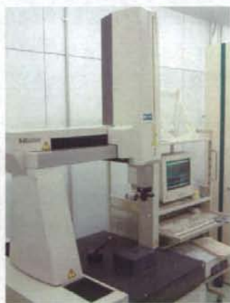
図 4. ミットヨ製CNC3次元測定器
