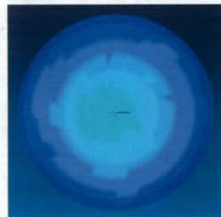
図 11-D. シミュレーション試験 1000 万回後の PMPC 処理 CLPE ライナー (40 mm) の摺動面コンター図
