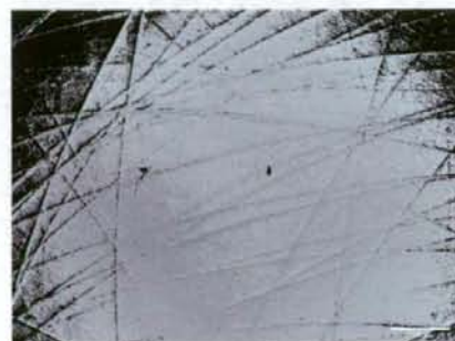
図 8-A. シミュレーション試験 1000 万回後の CLPE ライナー (32 mm) 摺動面の LSM 像
