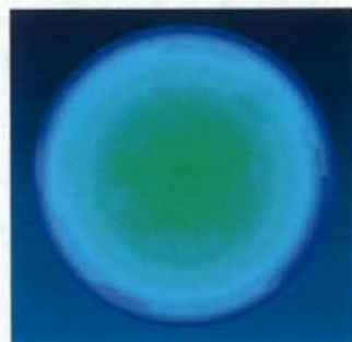
図 11-C. シミュレーション試験 1000 万回後の CLPE ライナー (40 mm) の摺動面コンター図
