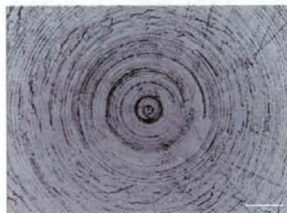
図 7-B. シミュレーション試験前の CLPE ライナー (40 mm) 摺動面の LSM 像
