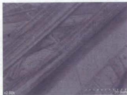
図 14-B. 試験前の Co-Cr 骨頭 (40 mm) 表面 SEM 写真
