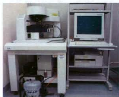
図 2. 走査型共焦点レーザー顕微鏡
