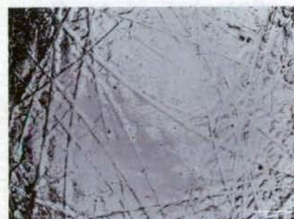
図 8-D. シミュレーション試験 1000 万回後の PMPC 処理 CLPE ライナー (40 mm) 摺動面の LSM 像
