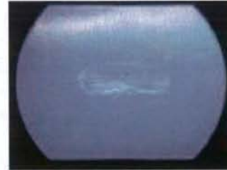
図 3-5. 100 万回後の酸化 CLPE (Oxidized CLPE) 摺動面のマイクロスコピーイメージ
