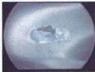
図 4-3. 20 万回後の酸化 CLPE (Ex-oxidized CLPE) 摺動面のマイクロSCOPIイメーJ
