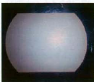
図 5-3. 20万回後の酸化 CLPE (Oxidized CLPE) 背面のマイクロSCOPEイメージ
