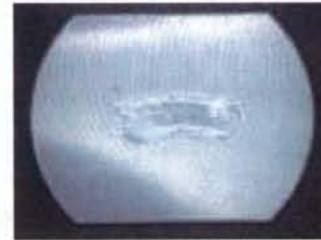
図 3-6. 200 万回後の酸化 CLPE (Oxidized CLPE) 摺動面のマイクロスコピーイメージ
