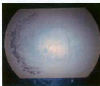
図 6-6. 200 万回後の酸化 CLPE (Ex-oxidized CLPE) 背面のマイクロSCOPEイメーJ
