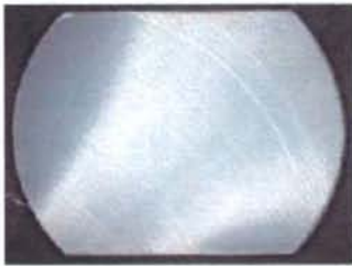
図 3-1. 試験前の酸化 CLPE (Oxidized CLPE) 摺動面のマイクロスコピーイメージ
