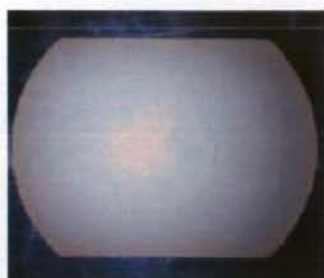
図 6-2. 5 万回後の酸化 CLPE (Ex-oxidized CLPE) 背面のマイク ロスコープイメージ
