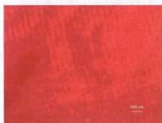
図 9 (b) . PMPC 処理 CLPE の蛍光顕微鏡写真
