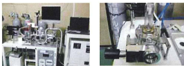
図 9. ハロゲン化物単結晶育成用チャンバー脱着型 \mu -PD 装置 (左) およびチャンバー部 (右) の概観。
