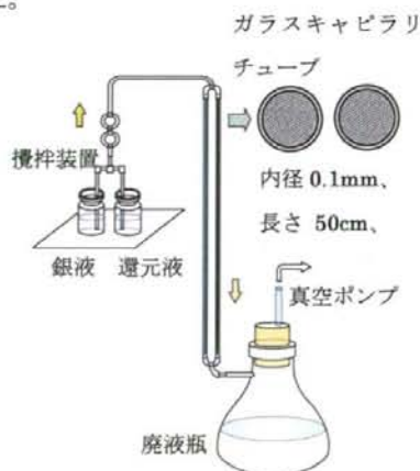
図 8 超細径銀中空ファイバの製作装置
