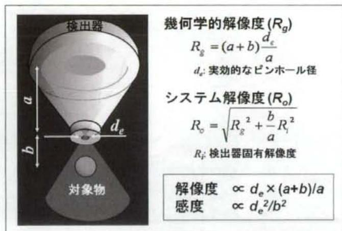
図1 ピンホールSPECTによる拡大撮像
