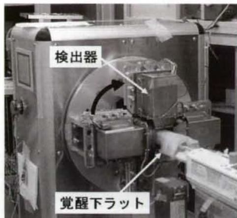
図5 われわれの開発した小動物専用マイクロSPECT装置
