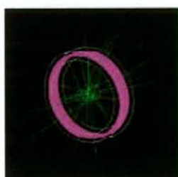
図2 モンテカルロシミュレーション。リング状(ピンク)に配置されているのがシンチレータである。
