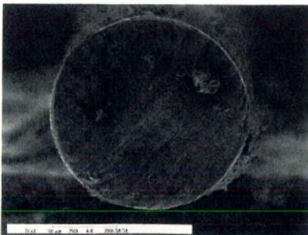
図 12 電子顕微鏡による触知ピン先端形状の撮像 Fig. 12 Picturization of the tip form of the tactile pin by an electron microscope.
