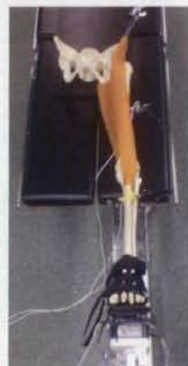
図1 製作した下肢骨折モデル
