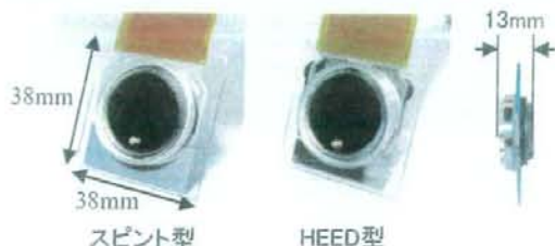
図7: 試作したFEA-HARP検出器
