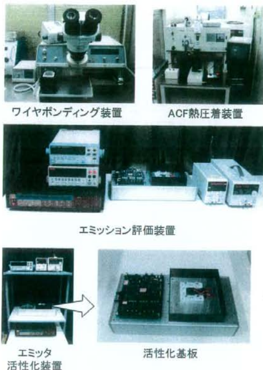
図8:FEA-HARP検出器内製化のための装置群
