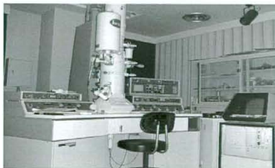
Fig. 6-1-08 複合電子顕微鏡システム 日本電子 JEM200CX
