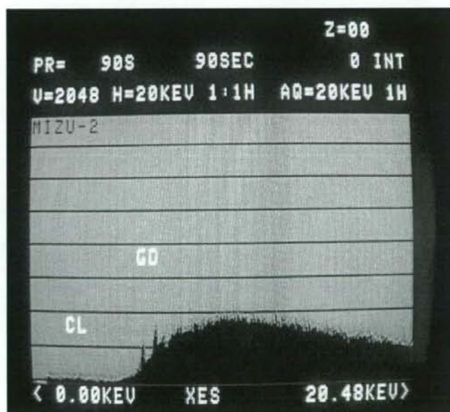
Fig. 6-1-19 血漿タンパクと Gd-DTPA-HMTA-D2-4Glc(OH)の混和による 特性 X 線の測定
