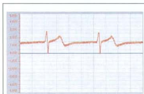
図11 計装アンプによる体表面心電図の増幅例
