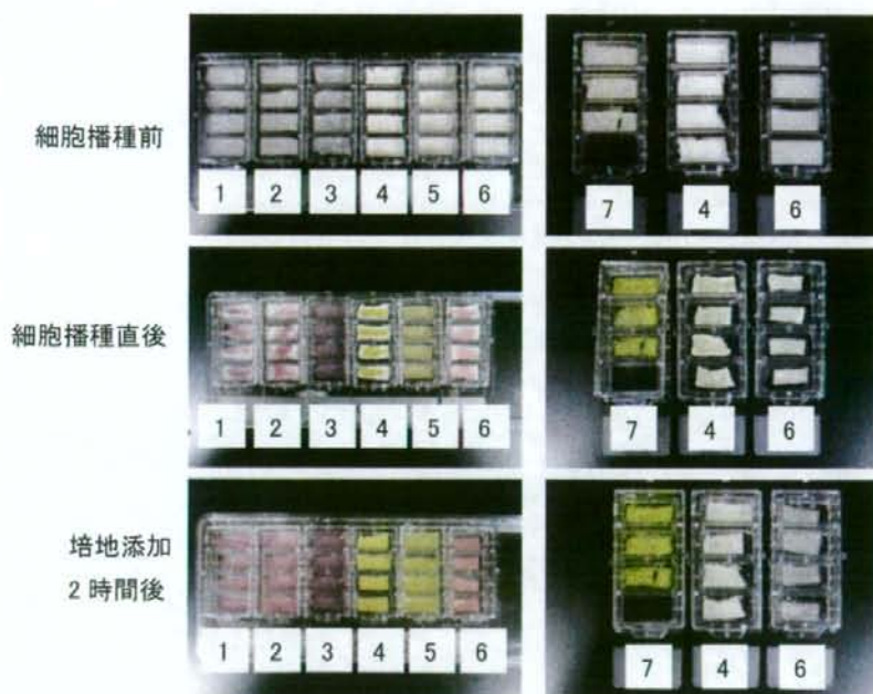
図 1. 3次元培養用スキャホールドの検討 細胞播種直後、タココンブ(7)は溶解した。7日間培養を続けた結果、アビテン(4)とサージセル(5)は形状を保持できず、非常にもろくなっていた
