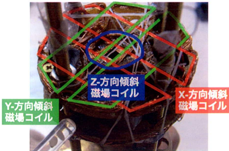
Fig.6: MRIプローブの試作2号機。傾斜磁場コイルの所を中心に写している。 3軸方向の傾斜磁場の生成が可能となっている。
