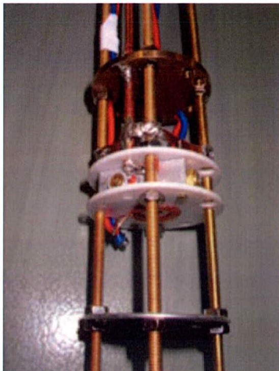
Fig.4: MRIプローブの試作1号機。中央の白いプレートが、傾斜磁場コイルのボビンである。
