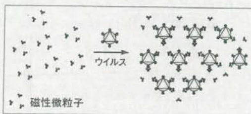
図3 ウイルスによる磁性微粒子の凝集構造
