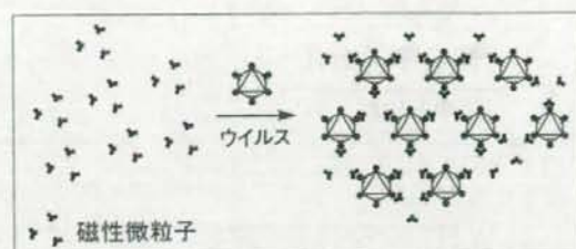
図3 ウイルスによる磁性微粒子の凝集構造
